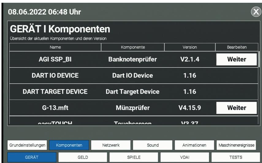
In diesem Menü (z.B. Banknotenprüfer) ist es möglich die Komponenten zu aktivieren bzw. deaktivieren. In diesem Menü können Sie auch direkt in den Testmodus der Komponente springen siehe „11. Tests“ auf Seite 58).
